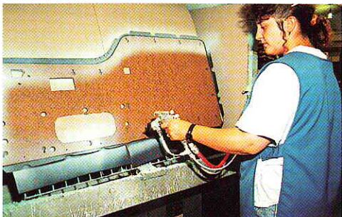
Espumas a madera, fieltros a acero y a tableros de fibras prensadas (Interiores de coches, autobuses y vehículos en general)
