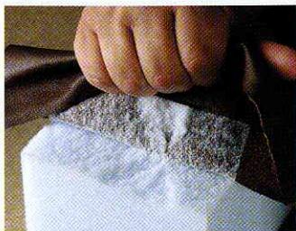
**Para unir cuero a espuma** - El adhesivo de espuma 3M™ Fastbond™100, con base de neopreno, une piel y espuma con una gran resistencia y proporciona una línea de unión flexible que se complementa con la flexibilidad del cuero.
